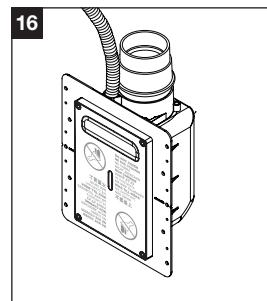
Si se instala este sistema en Europa, pasar el cable bajo voltaje en la funda eléctrica UTCA, como para cualquier otra instalación de aspirador central, y tirar de la funda por encima de los cables de la toma y dentro de la apertura prevista (figura 16).
